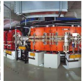
• Die **GSI-Beschleunigeranlage** besteht aus drei Abschnitten: Driftröhrenbeschleuniger UNILAC (links), Schwerionen-Synchrotron SIS18 (Mitte) und Ionenspeicherring ESR (rechts). Für FAIR werden diese Systeme als Vorbeschleuniger weiterverwendet. (GSI)
