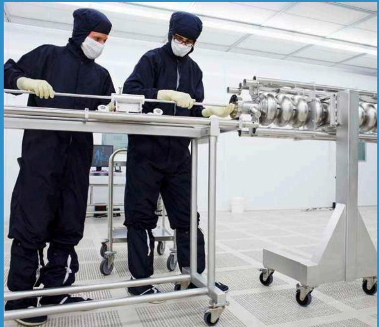
Industrielle Fertigung von **supraleitenden Hohlraumresonatoren** für den European XFEL (Zanon)
