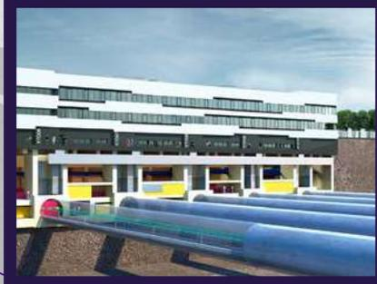
Mit den einzigartigen Röntgenblitzen des Freie-Elektronen-Lasers **European XFEL** werden sich unter anderem dreidimensionale Aufnahmen aus dem Nanokosmos machen und chemische Reaktionen filmen lassen. Angetrieben wird die Strahlungsquelle von einem rund 2 Kilometer langen supraleitendem Elektronenbeschleuniger, dem längsten seiner Art.
