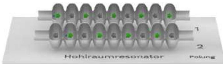
• Beschleunigung eines Elektrons in einem **Hohlraumresonator** zu zwei verschiedenen Zeitpunkten. Die Pfeile zeigen in Richtung der elektrischen Kraft. Sie sind grün, falls das Elektron in Bewegungsrichtung beschleunigt würde; sie sind grau, falls das Elektron abgebremst würde. Das elektrische Kraftfeld ist so auf die Bewegung des Elektrons abgestimmt, dass das Teilchen nie abgebremst wird.
