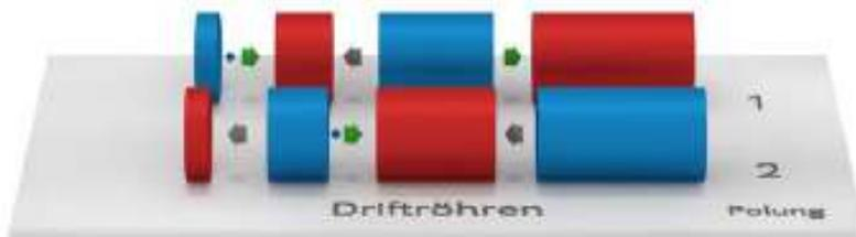
• Beschleunigung eines Elektrons mittels **Driftröhren** zu zwei verschiedenen Zeitpunkten. Die Pfeile zeigen in Richtung der elektrischen Kraft. Sie sind grün, falls das Elektron in Bewegungsrichtung beschleunigt würde; sie sind grau, falls das Elektron abgebremst würde. Wechselfeld und Länge der Röhren sind auf die Bewegung des Elektrons abgestimmt, so dass das Teilchen nie abgebremst wird.
